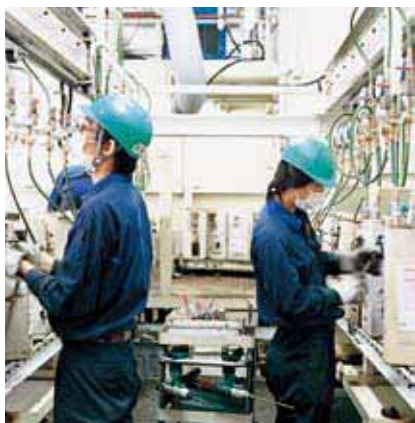
家電メーカーのリサイクルプラントに持ち込まれ、フロンガスが回収されるエアコン。 写真/大河内楨
