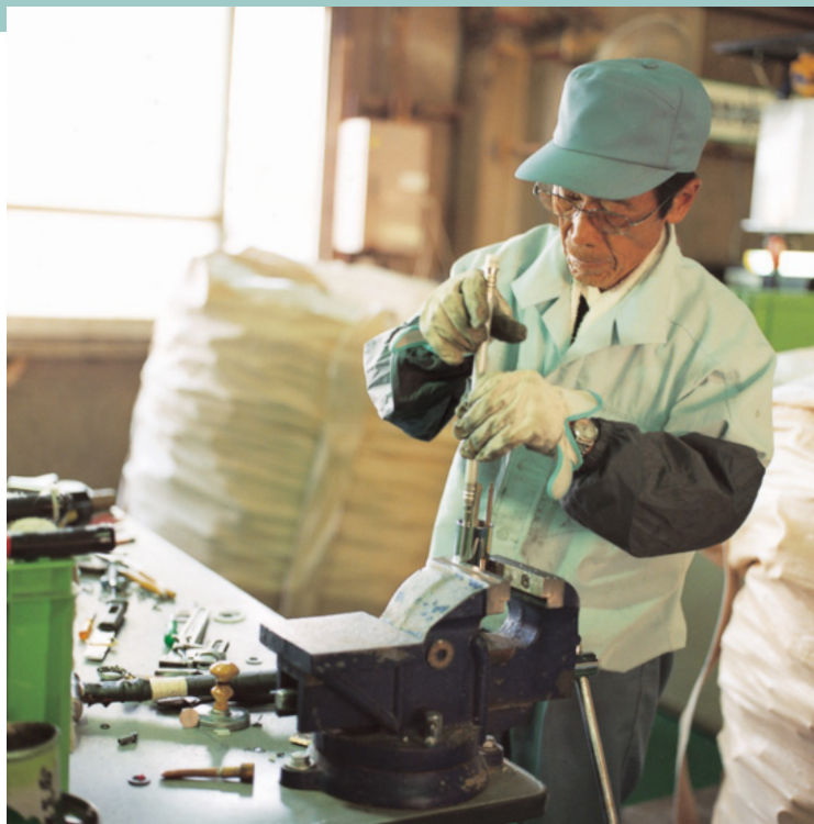
水栓金具類を手分解。異質な資源が混合していることが多く、最も技術を要する過程といわれている。
