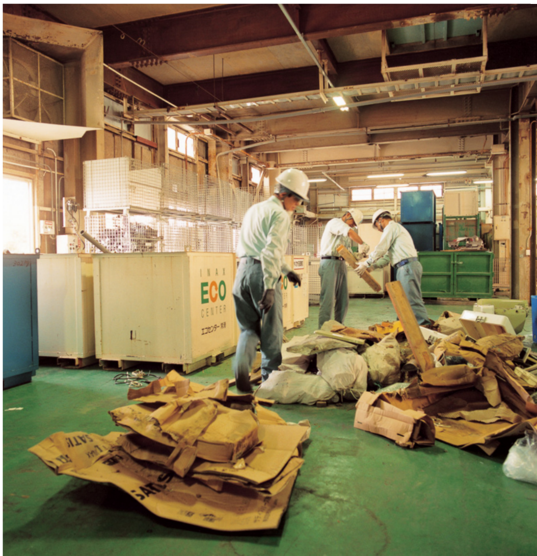
住宅リフォーム工事で出た廃材は、専用の回収コンテナで丸ごとエコセンターに運ばれ、分別される。
