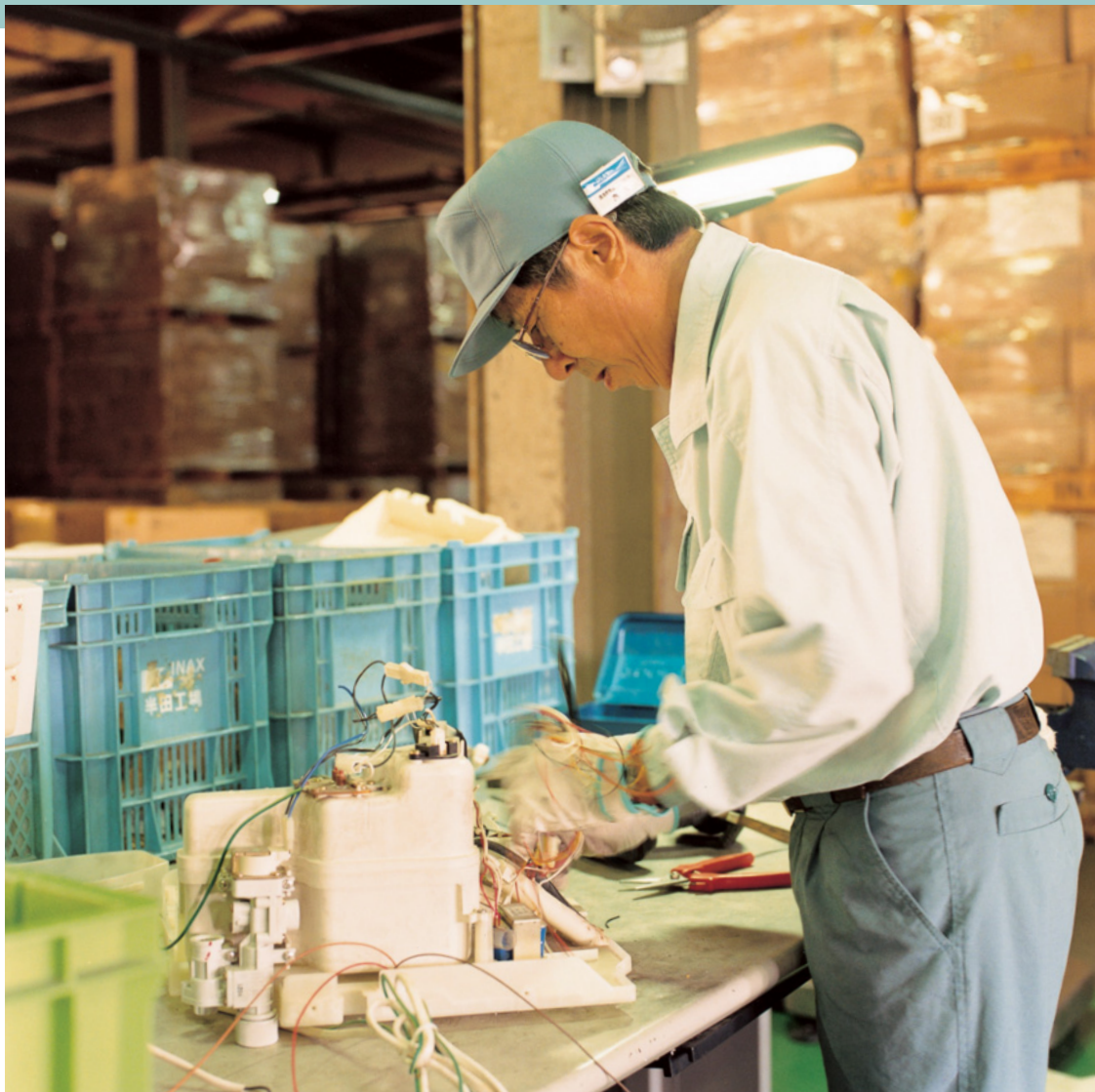
シャワー式トイレを手分解する職員。コード類も1本1本手で取り外す。
