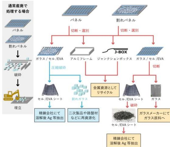
回収した太陽光パネルは各処理方法により、素材ごとにリサイクルされます。
