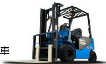
(図2) 新型電動フォークリフト例 (※Li-ion電池搭載(3.0t,3.5t,4.0t))
