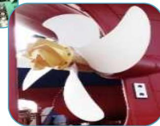
CFRPプロペラ
