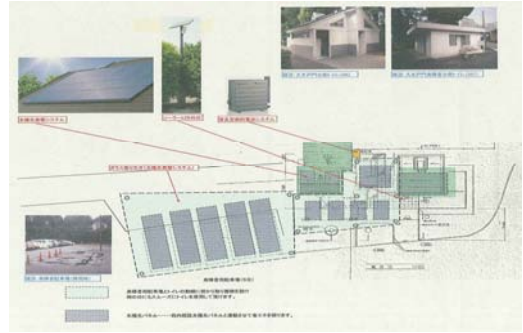
太陽光パネル設置・燃料電池導入
