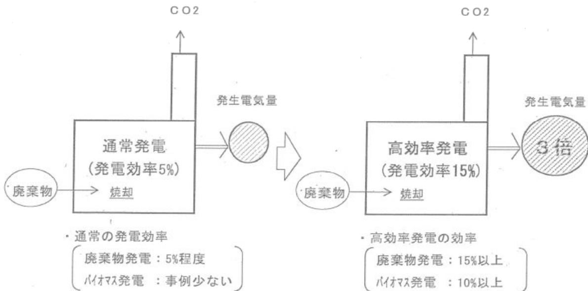
例えば、発電効率が3倍（5% 15%）になると、同じ廃棄物を焼却しての発生電気量が3倍になり、増えた電気量に見合う化石燃料由来の二酸化炭素を抑えることが可能。
