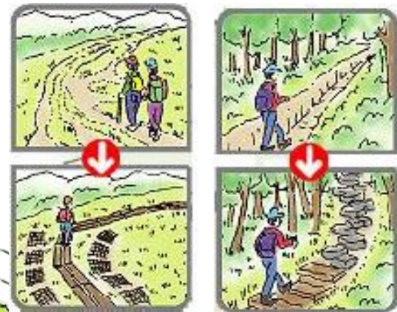
本道整備と植生復元 洗掘箇所の復元
