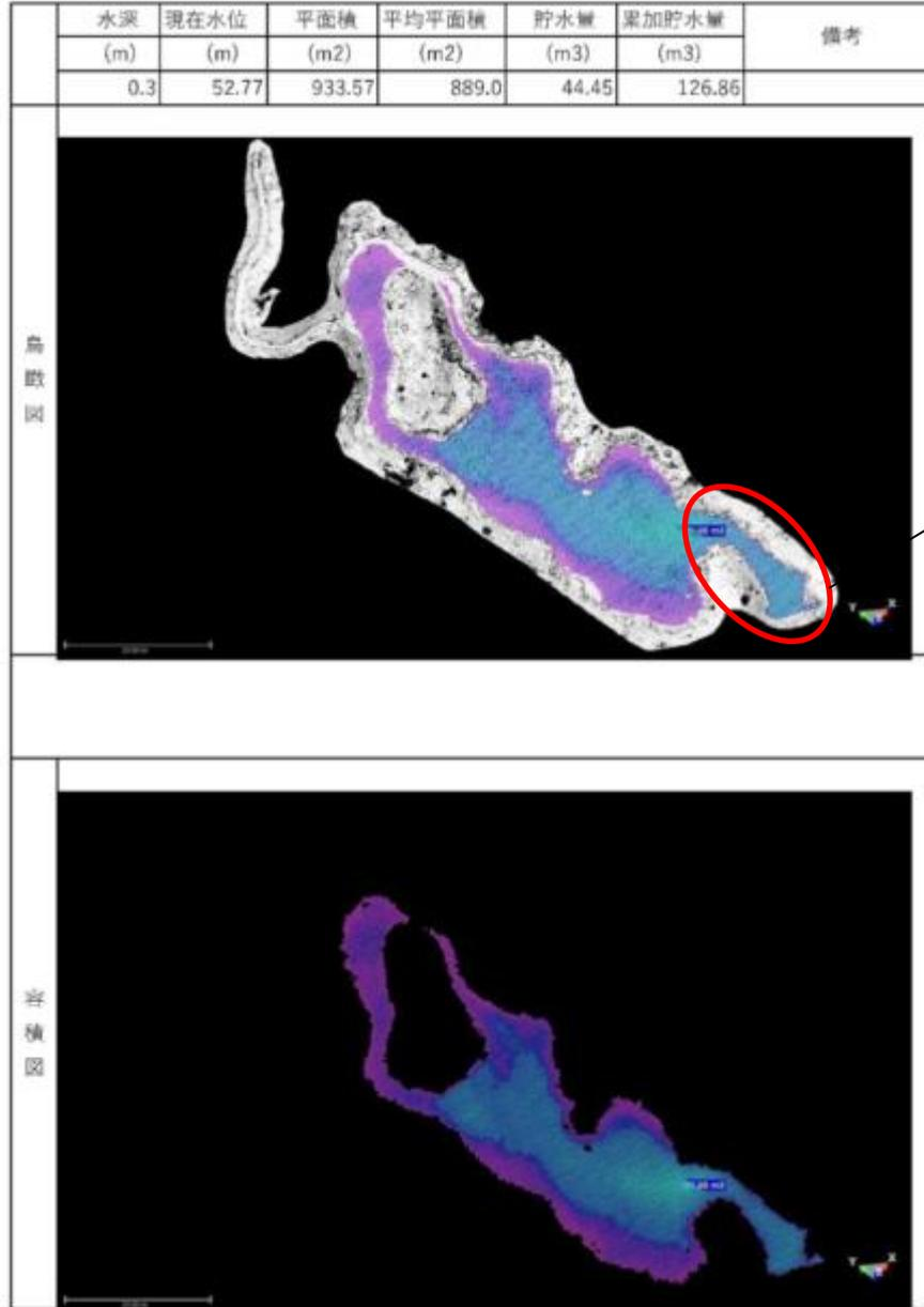
図 3.11 貯水位変化鳥瞰図 水深 0.30m
