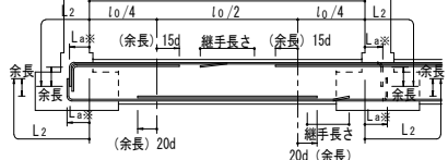
図 4. 6 主筋の継手、定着及び余長(その2)
