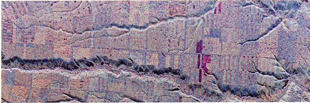
Figure.1(a) Lバンドの偏波合成 SAR 画像 (R, G, B に HH, HV, VV 偏波が対応.)
