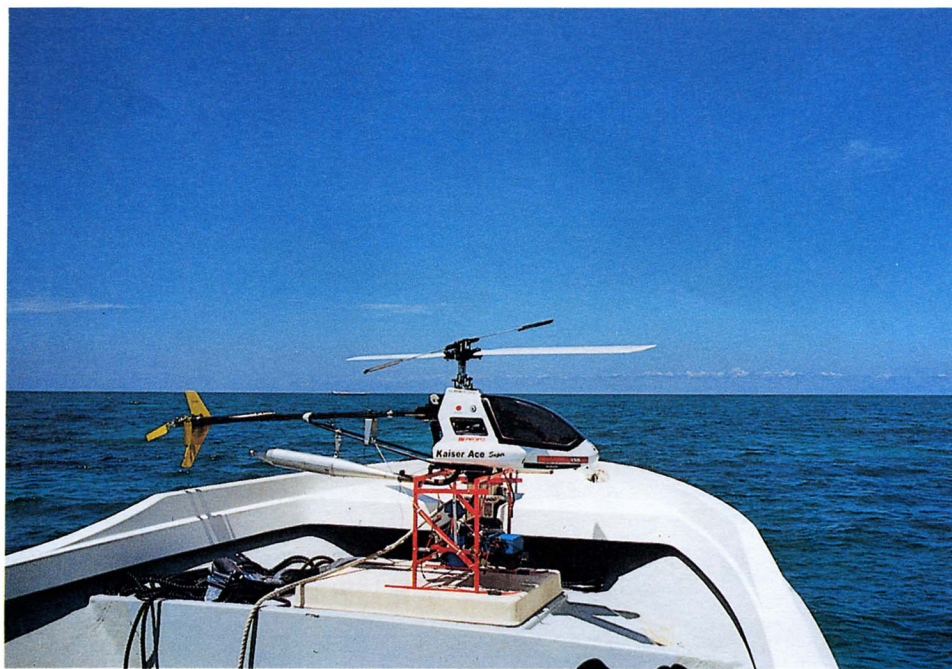
図 2 デジタルカメラを装備した模型ヘリコプター
