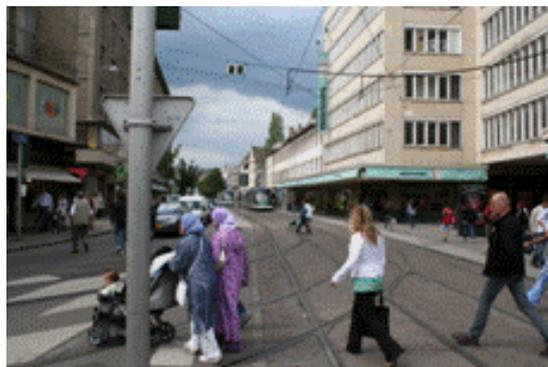
写真12 沿道建物を利用して張られた架線(ストラスブール)
