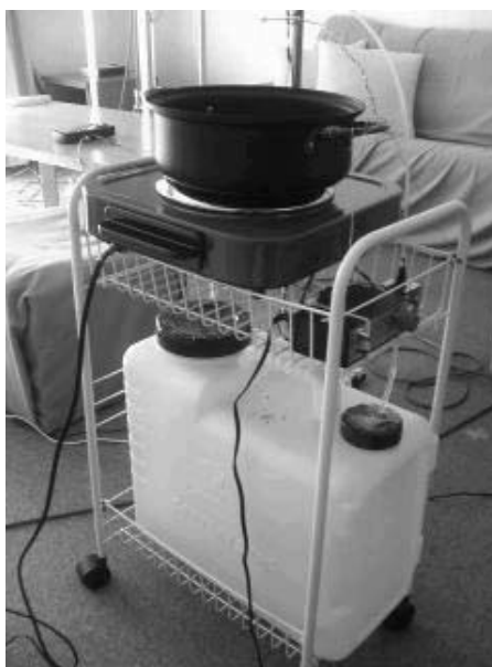
図2-2-1-9 水蒸気発生装置
