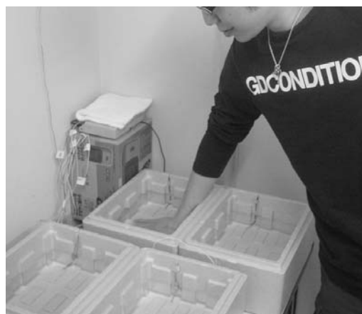
写真 2-2-4-3 溜め水による水温判定実験
