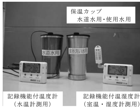
写真 2-2-4-2 水温、室温・湿度計測用器具
