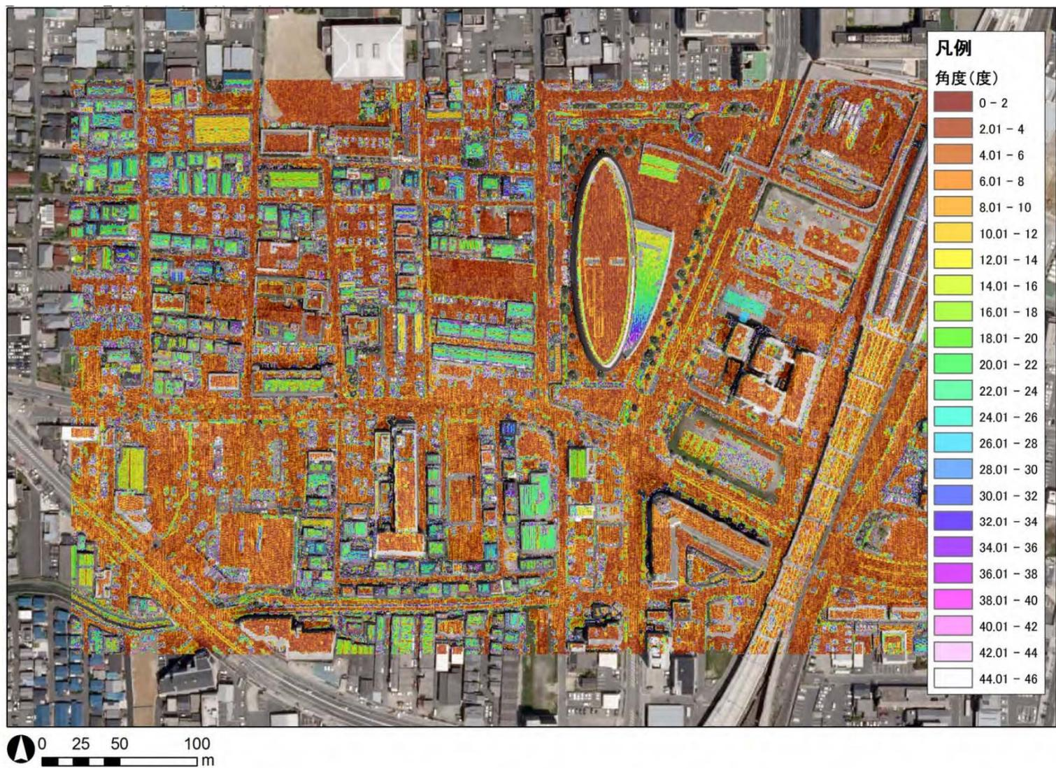
図 6. 4-17 航空レーザ計測データによる傾斜角の表現
