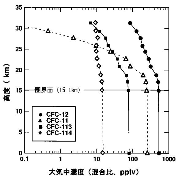
図2-資-2 三陸上空におけるCFC-11、CFC-12、CFC-113及びCFC-114の高度分布
