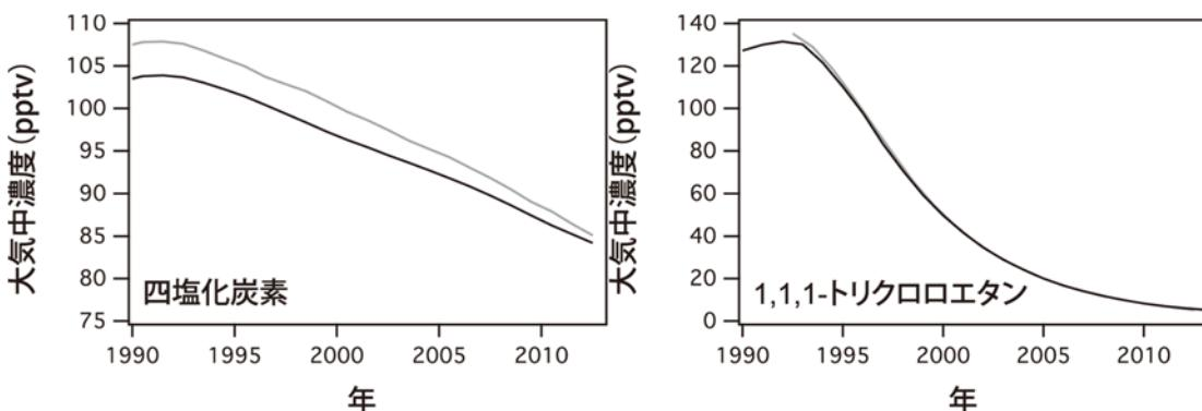
図 2-3-14 海外のネットワークで観測された四塩化炭素及び 1,1,1-トリクロロエタンの濃度変化
