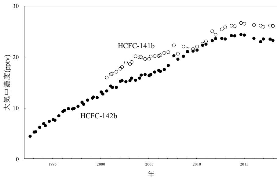
図 2-3-6 北海道における HCFC-141b、HCFC-142b の大気中のバックグラウンド濃度の経年変化
