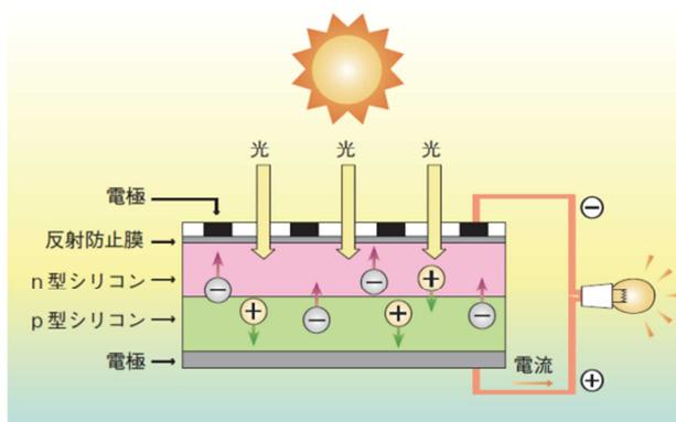
図 3-1 太陽光発電（シリコン系）の仕組み
