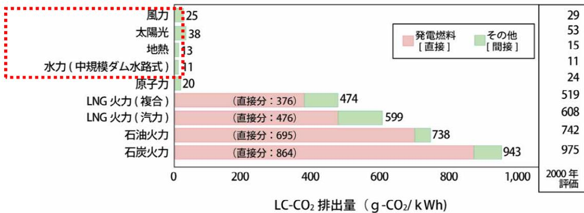
図 1-3 日本の発電技術のライフサイクル CO<sub>2</sub> 排出量評価
