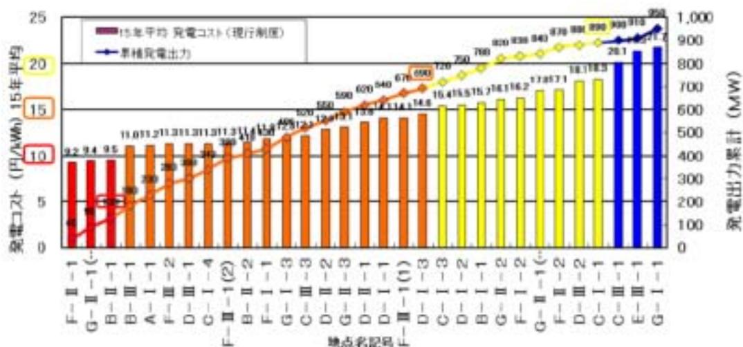
図 6-3 NEDO 地熱開発促進調査結果に基づく地熱開発発電コストおよび発電出力累計
