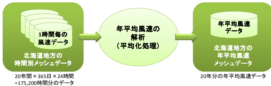
図 2-13 時間別風速データから年平均風速データに変換する処理の概念図
