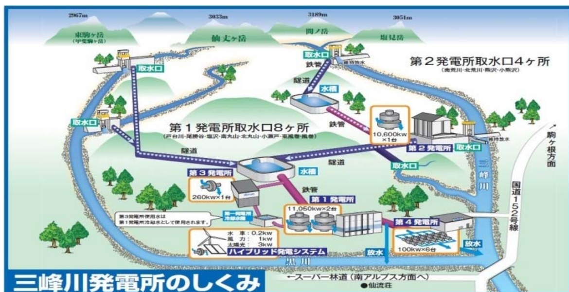
図 4-7 三峰川発電所のしくみ
