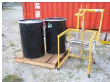
図 8.2-17 溶剤入りドラム缶と手動式ドラム缶用減容機
