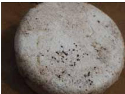
図 8.2-19 減容時間が短い発泡スチロールの例
