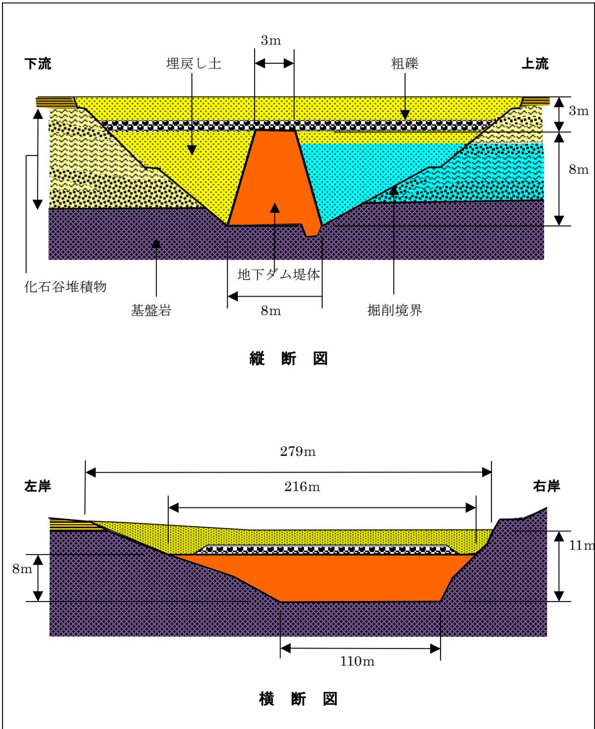
図 4.1 : 地下ダムの構造概略図
