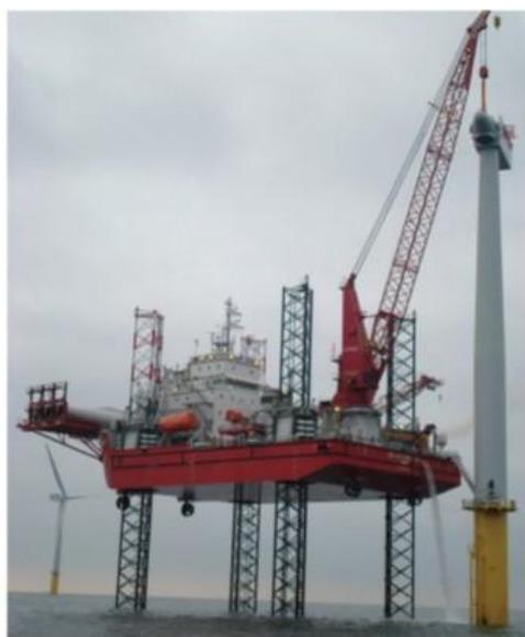
図 4-99 タービンを設置する大型の洋上作業船
