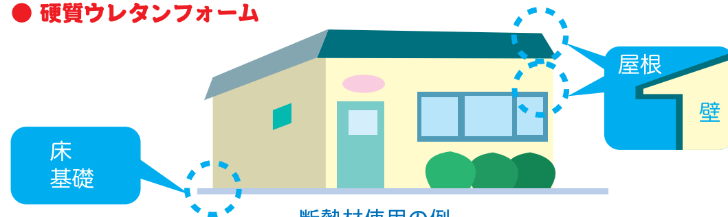
断熱材使用の例
