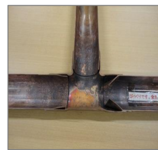
銅管を縦割り
