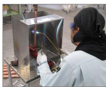
前からのろう付け作業
