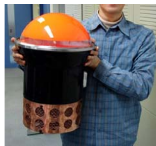
図 5.1 開発された二酸化炭素を測定するための 小型漂流ブイ
