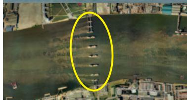
イギリスでは、テムズ川河口の施設改良に取り組んでいる。海面水位よりも低い土地を守るため、延長18kmにも及ぶテムズ防潮堤を設置し、年10回程度の高潮に際してゲートを閉じて対応している。
