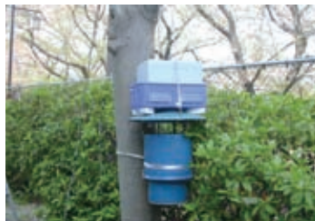
ドライアイスを用いた捕獲器*
