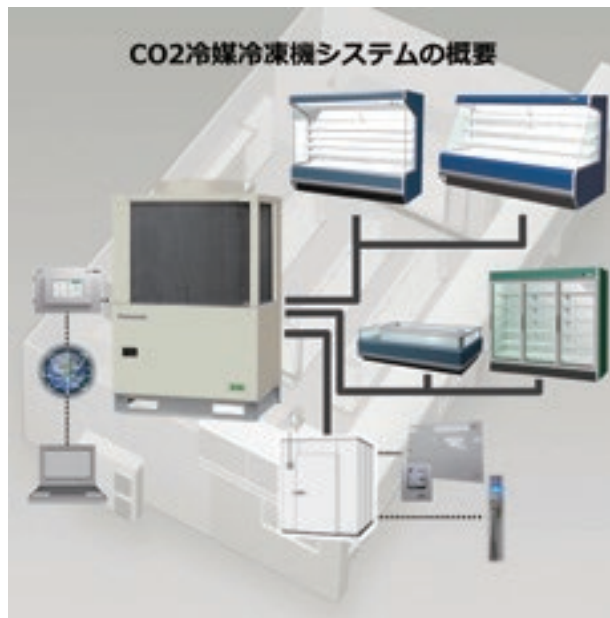
CO 2 冷媒冷凍機システムでCO 2 排出量削減
