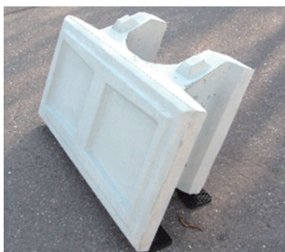
アルカリ活性材料コンクリートで製造したプレキャストコンクリート製品の単品の外観
