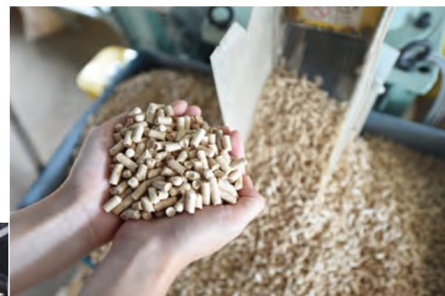
製作時に発生するおがくずをペレットに加工
