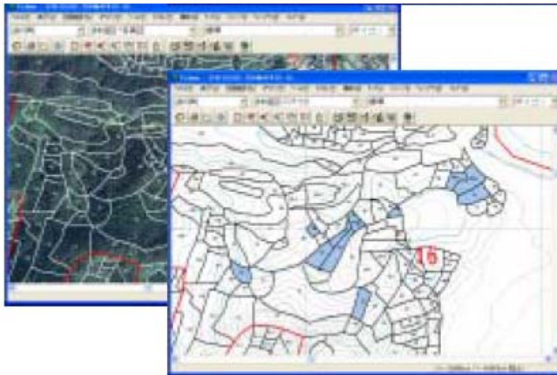
図 II-1 森林 GIS 情報に基づき間伐等の森林施業が行われた面積を測定する方法
