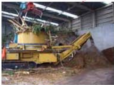
●1次破碎機 間伐材や建設廃材を100mm以下まで効率よく破碎します。
