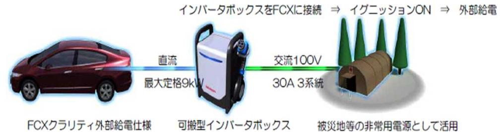
燃料電池電気自動車に搭載されているFCスタック（発電装置・最大出力100kW）を用い、外部へ電源出力できる機能を開発・搭載し、**「移動可能な発電機」**として有効に活用する
