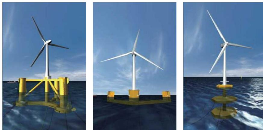
コンパクトセミサブ型 字型セミサブ型 アドバンストスパー型
