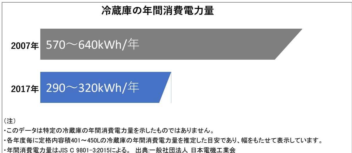
図 11 製造時期による冷蔵庫の年間消費電力量の比較
