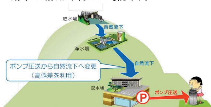
自然流下による送配水範囲の拡大 [1]
