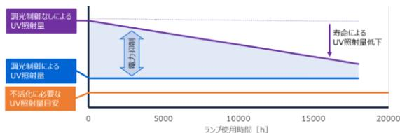
紫外線照射量制御による電力抑制<sup>[1]</sup>
