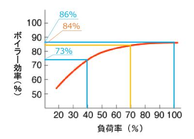
全体のボイラー効率はボイラー効率の蒸気負荷による加重平均値(以下の式により算定)とした。 (蒸気負荷A×ボイラー効率A+蒸気負荷B×ボイラー効率B) ÷ (蒸気負荷A+蒸気負荷B)
