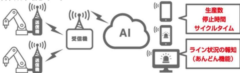
「製造ラインモニタリングサービス」の構成<sup>[1]</sup>
