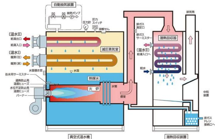
出所) [1]株式会社日本サーモエナ「温水機・温水ボイラ ガス焚 潜熱回収型真空式温水発生機」
