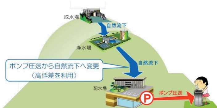
自然流下による送配水範囲の拡大 [1]
