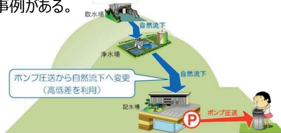
自然流下による送配水範囲の拡大 [1]
