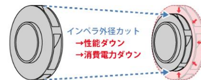
ポンプの羽根車（インペラ）カットのイメージ [3]
