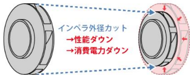
ポンプ羽根車のインペラカットのイメージ[1]
