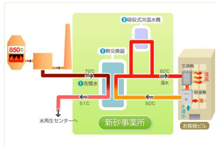
洗煙排水からの熱回収利用の例 [2]
