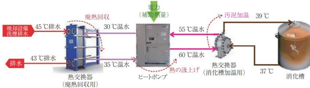
洗煙排水からの熱回収利用の例 [1]
