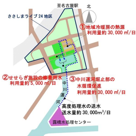
下水熱による地域冷暖房の例 [1]
