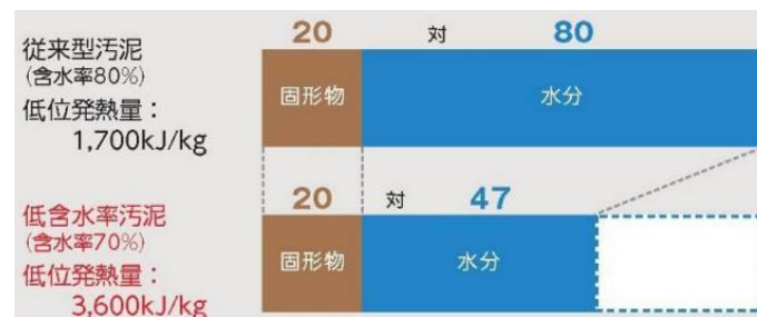
汚泥低含水率化による発熱量増加の例 [1]
