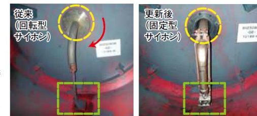
▲ドレン排出装置（シリンダードライヤー内部）
