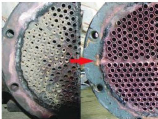
スケール除去前後の熱交換器内面 [1]
