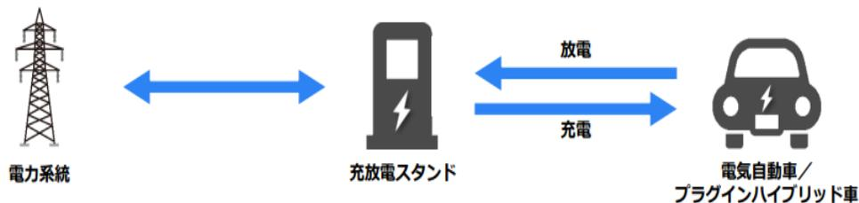
日射量の多い昼間など、再生可能エネルギーの発電量が多くなる時間帯には、電気自動車の蓄電池に充電し、夕方など電力需要が伸びる時間帯には、蓄電池から放電
