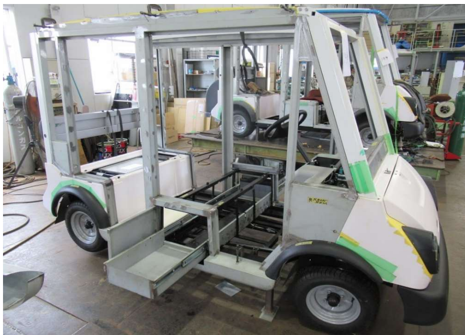
図 2.1.1.4-2 側面補強、スライド式電池室、車幅拡張
