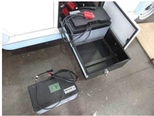
固定ボルトを外し 電池を降ろした
