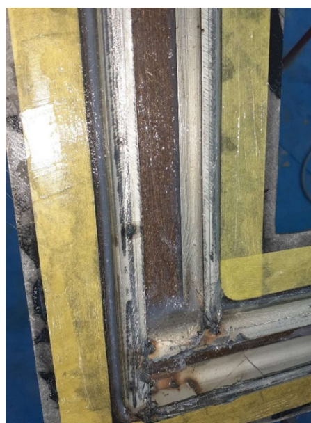
図 2.1.1.2-4 CNF パネルと鋼製枠接着
