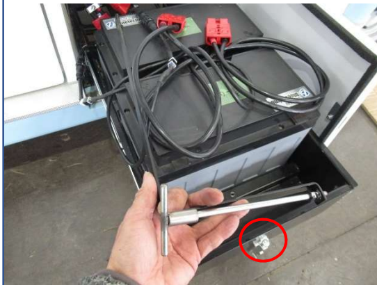
電池の固定ボルト（手で操作可能） 電池トレー解除ロック（赤丸）
